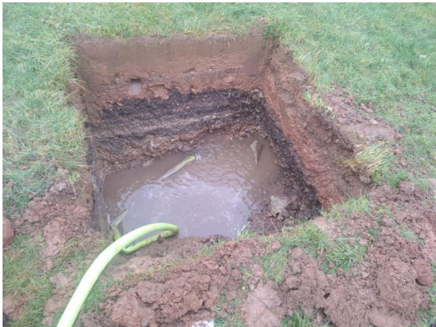
Abb. 2 – Versickerungsversuch VV im Schurf S 2, 15.01.2025
